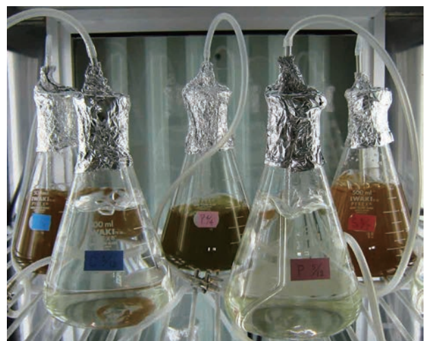
藻類の生長阻害試験を実施する様子 (フラスコ内に試験水で藻類を育て、生長の遅滞や枯死を見ている)
